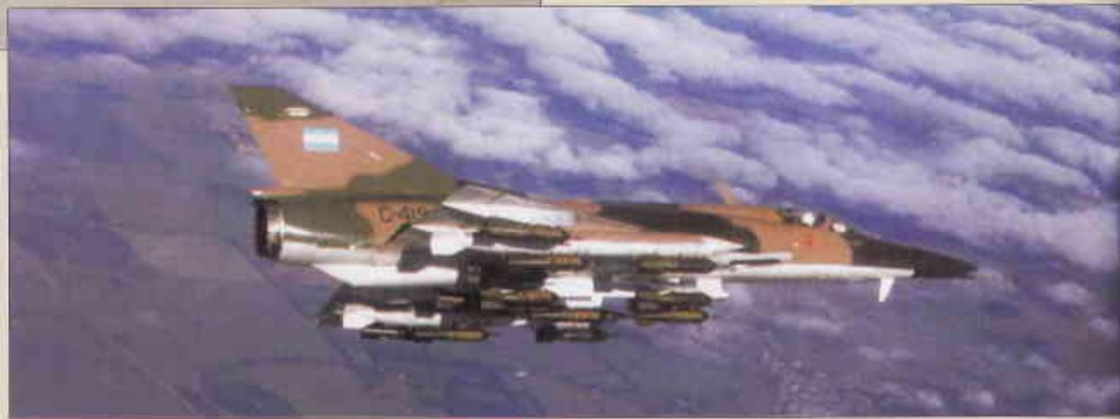
Dagger C-419 con carga máxima de 16 bombas de 125 Kg,destacándose el empleo de los tanques portabombas supersónicos MadNap de 500 lts.(Fuerza Aérea).
