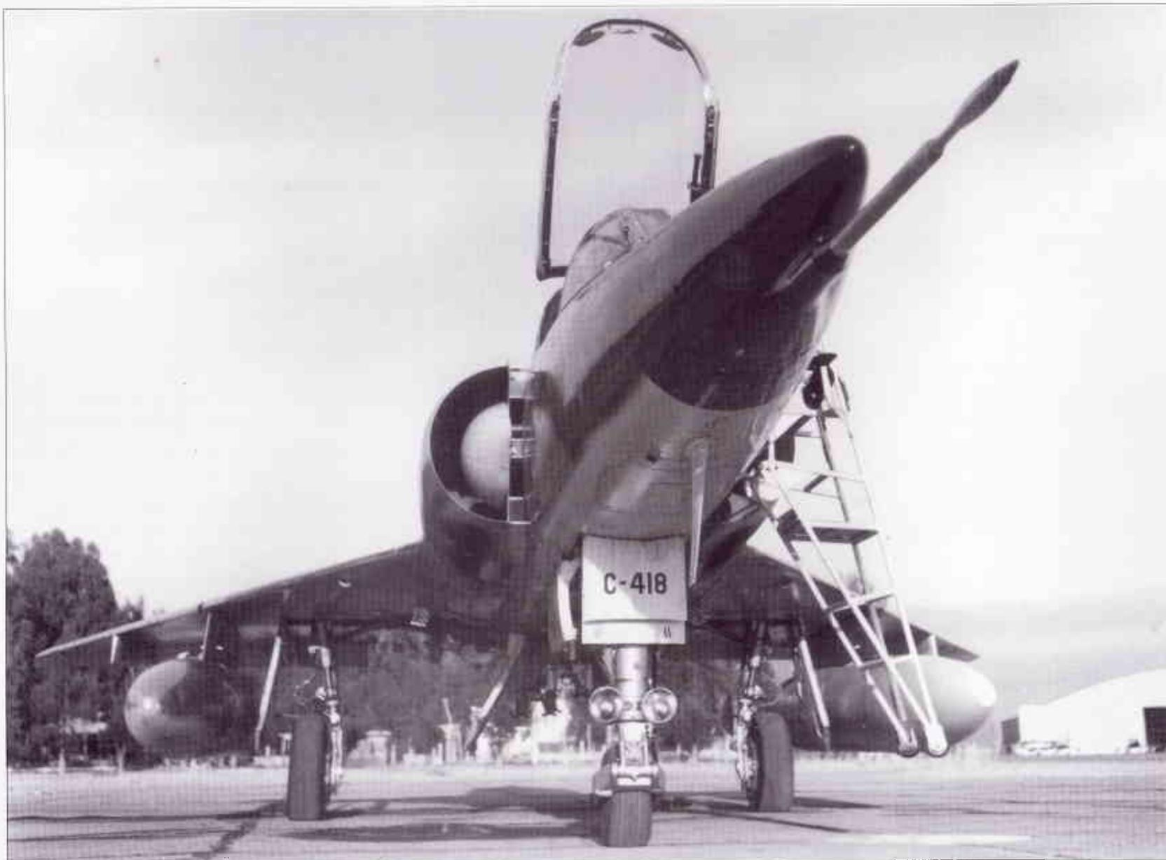
Dagger C-418 en configuración standard para prácticas de bombardeo: tanques pendulares de 1300 lts y soporte ventral con adaptadores para cuatro bombas (Jorge Núñez Padín)
